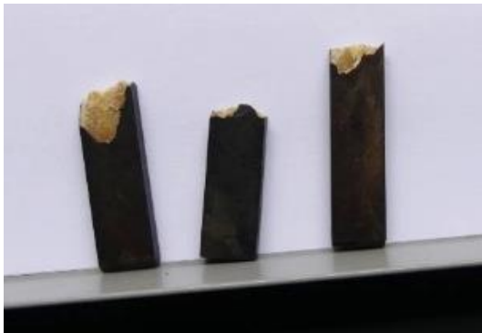
Versprödete und stark verfärbte Prüfkörper des PPA (6T/6) GF35 nach Lagerung in Kühlmittel (Wasser / Glykol) für 1.000 h / 150 °C.
